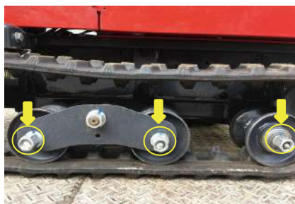
左右のクローラー転輪固定ナット6ヶ所
